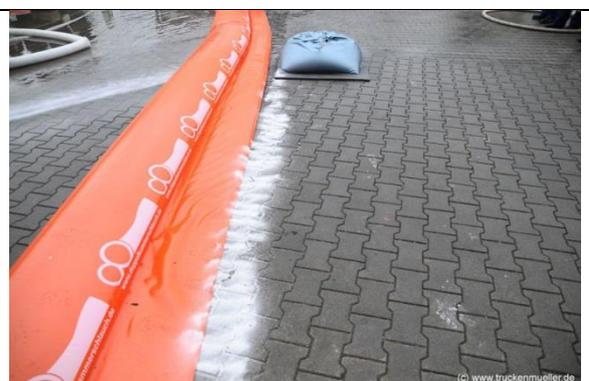
Der Doppelkammerschlauch richtet sich eigenständig auf
