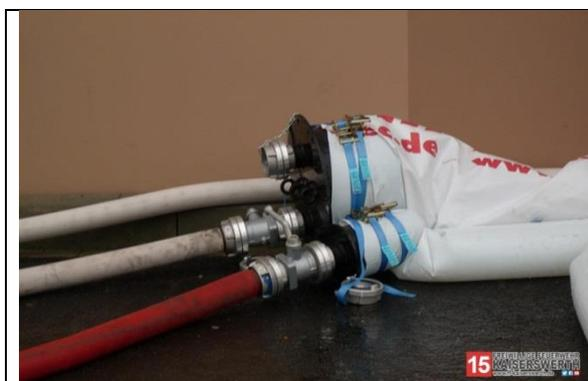
Angekuppelte Füllarmatur mit zwei Zubringerleitungen
