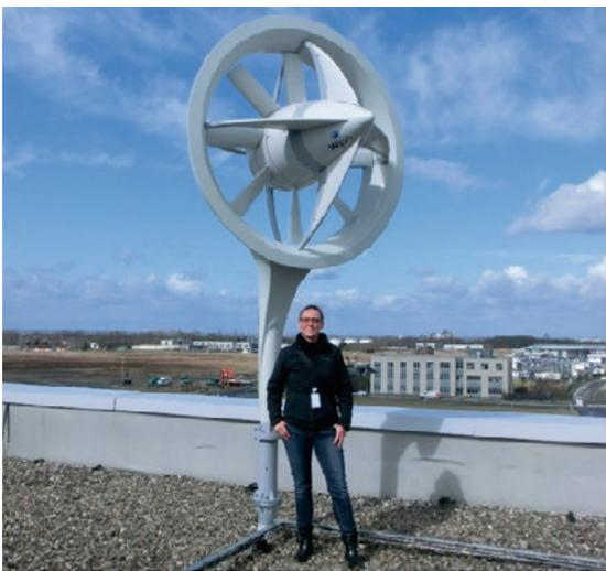
**Baugenehmigungsfreie Kleinwindenergieanlage (KWEA) Mantelturbine, Aufdachanlage**
