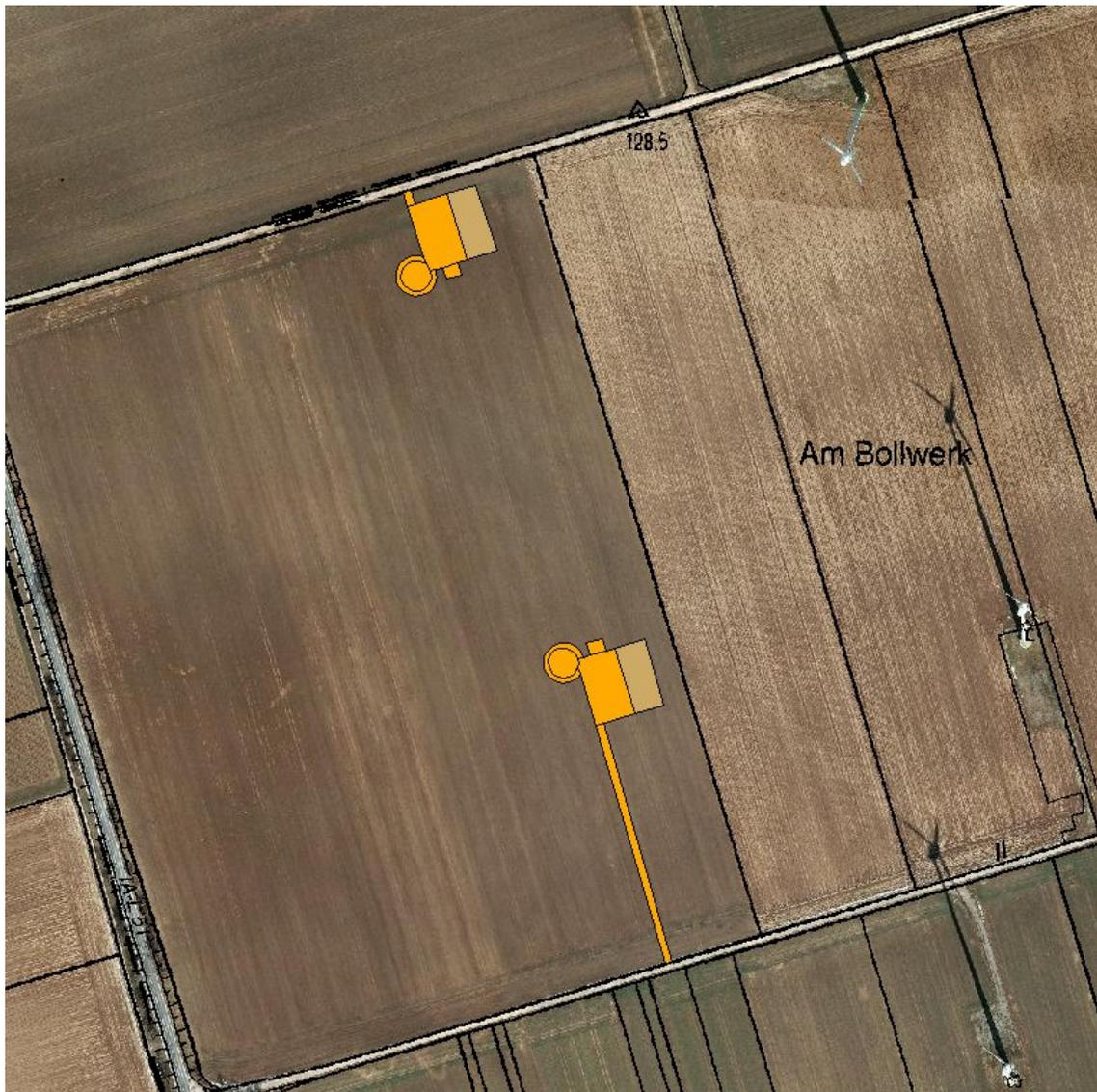
**Abbildung 31:** Charakterisierung des Vorhabens hinsichtlich der Eingriffsrelevanz. Der dauerhafte Eingriff auf Ackerflächen ist gelb, der temporäre Eingriff hellbraun markiert. Die Flächengrößen sind dem Datenblatt der ENERCON E-53 entnommen (Quelle: ENERCON 2007).
