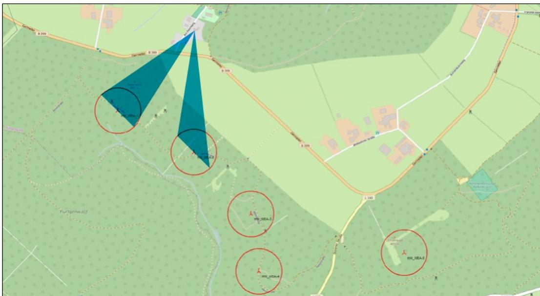
**Abb. 33: Ausrichtung der WEA bei SW-Wind (Standort Am Peterberg 4)**
