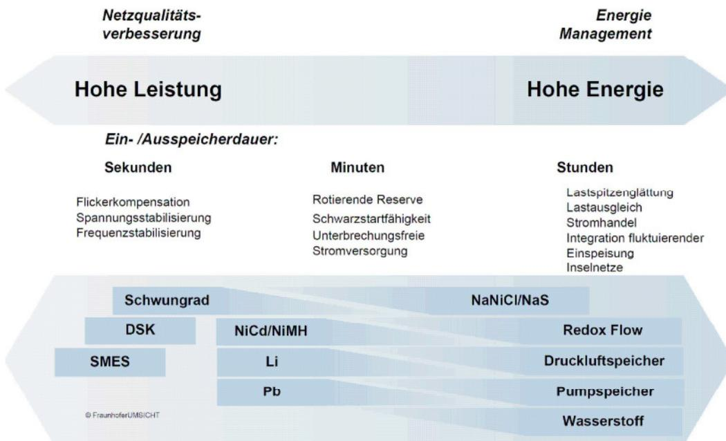
Abbildung 10: Einteilung von elektrischen und elektro-chemischen Energiespeichern
