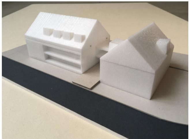
VARIANTE 3, Dachgeschoss als Staffelgeschoss mit leicht geneigtem Dach 16°
